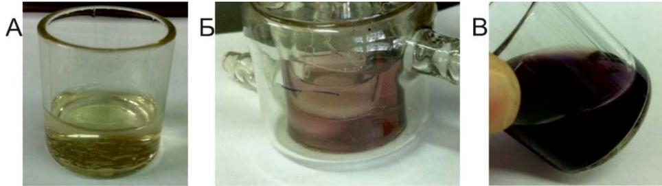
Рис. 2.20. Фото раствора 2.0 мМ  $MV^{2+}$  + 1.5 мМ  $AuCl$  + 75 мМ PVP: (А) исходный, (Б) после восстановления при  $E = -0.90$  В,  $Q = 0.2$  F и (В) 1.1 F в расчете на  $AuCl$ . Среда:  $H_2O/0.1$  М  $NaCl$
