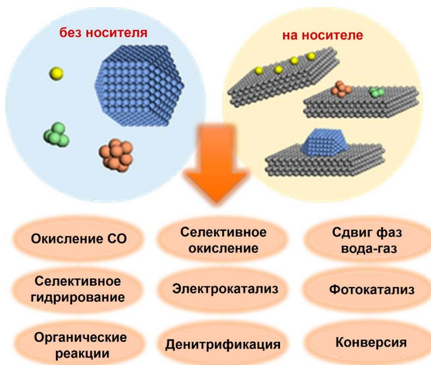
Рис. 1.34. Варианты гетерогенных каталитических реакций, в которых в качестве катализаторов могут быть использованы атомы, кластеры и НЧ металлов [486]
