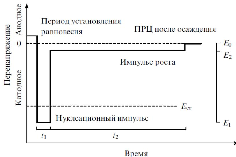
Рис. 1.14. Схема импульсов потенциала, применяемая с целью увеличения монодисперсности электролитических осадков. ПРЦ - потенциал разомкнутой цепи,  $E_{ст}$  – критический потенциал нуклеации,  $E_0$  – потенциал после завершения осаждения,  $E_1$  – потенциал образования зародыша,  $E_2$  – потенциал роста зародыша [151]
